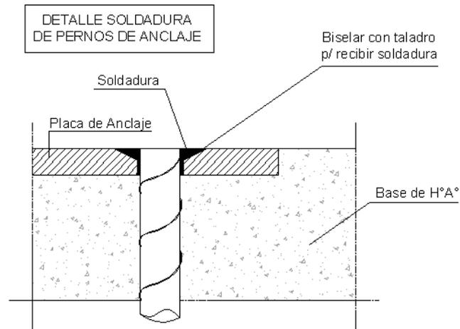
**SOLDADURA:** Se soldarán "el perfil, las cartelas y la placa de anclaje" en todo el perímetro de contacto.-
