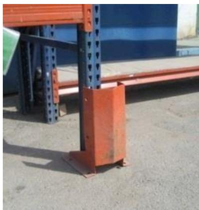
Deben quedar fijadas al piso en un mínimo de 4 puntos. Los tornillos de las fijaciones a piso deben ser en todos los casos amolados al ras de la tuerca
