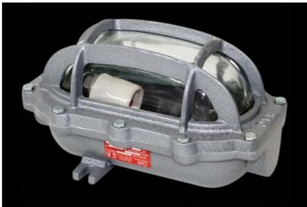
Para la iluminación interna del recinto con peligro de explosión, se utilizaran este tipo de artefacto tipo “tortuga”, los vidrios deben estar sellados a la reja. Material de cuerpo y reja en fundición de aluminio, vidrio de borosilicato, portalámparas rosca E27. Pintura nitrosintética color gris. Accesos: 2 a 180° de 3/4”.
