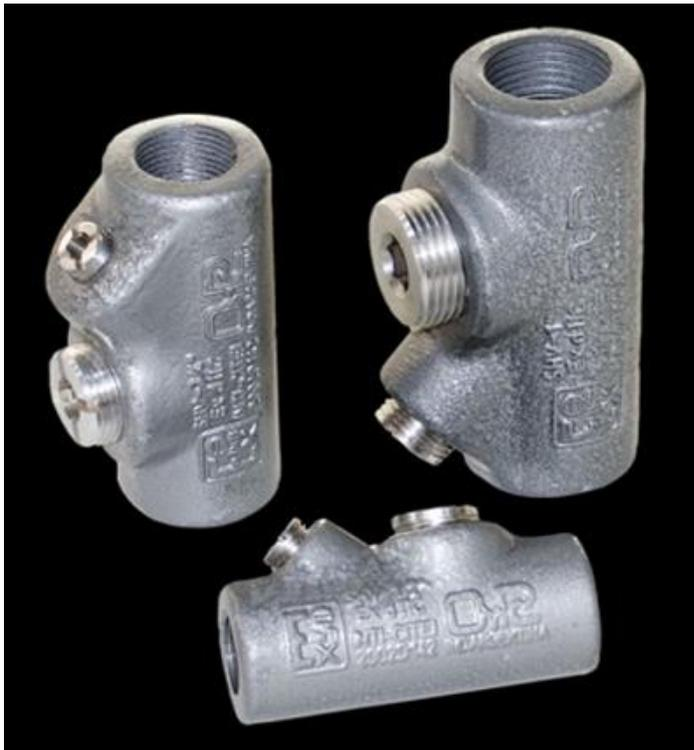
Los selladores universales, se utilizarán en los sistemas de cañerías para impedir el pasaje de gases, vapores o llamas, desde una parte de la instalación a otra a través de las tuberías, limitando cualquier explosión a su caja generadora. Su utilización es tanto para sellar cañerías en posición horizontal como vertical. Material de cuerpo en fundición de aluminio, pintura nitrosintetica gris.
