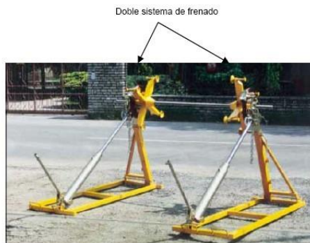
Figura 18.- Sistema frenado en alza bobinas
