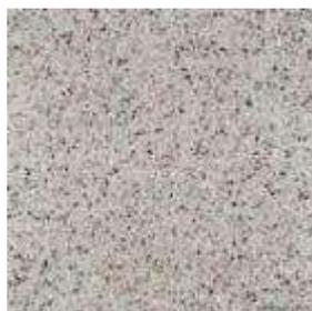
Dicho mosaico será colocado con un mortero a la cal. Las aristas de los mosaicos serán rectilíneas sin mellas ni rebarbas, carecerán de cavidades y grietas, permitirán colocarse con juntas no mayor a 1 mm. Los solados deberán realizarse con pendiente mínima hacia las rejillas de desagüe del 1%.
