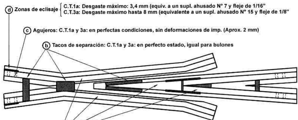
C.T.1a: Desgaste máximo: 3,4 mm (equiv. a un supl. ahusado N° 7 y fleje de 1/16")
